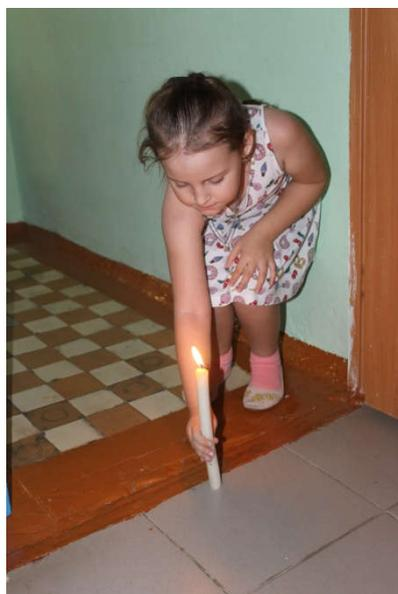
Пламя наклонилось в сторону группы. Холодный воздух идёт из коридора низом. Подняли свечу вверх, пламя отклоняется в сторону коридора.
